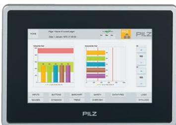
Terminales de operador PMIvisu con software de visualización PASvisu.
